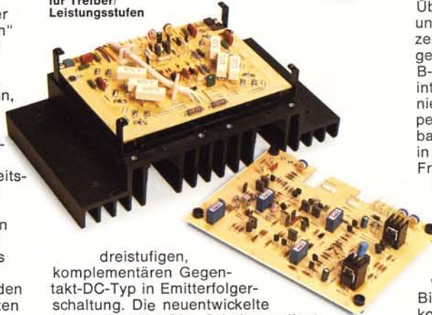
Platinen und Kühlkörper für Treiber/Leistungsstufen
